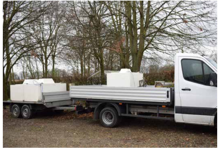
Het transport vindt plaats in geïsoleerde tanks, waarin het water 24 uur op 1°C blijft.
